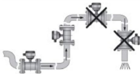
Figuur 8: correcte installatie op laagste punt (links); foutieve installatie op hoogste punt (boven) en voor open uitlaat (rechts) (Vito, 2019, Code van goede praktijk voor installatie, onderhoud en controle van meetinrichtingen voor opgepompt grondwater)
